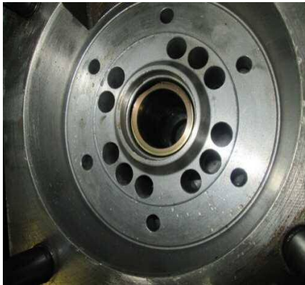
Overlap cylinder အတွက်- အပေါ်ကို ၆၀ ဒီဂရီ အောက်ကို ၂၀ ဒီဂရီပေးထားတယ်။
