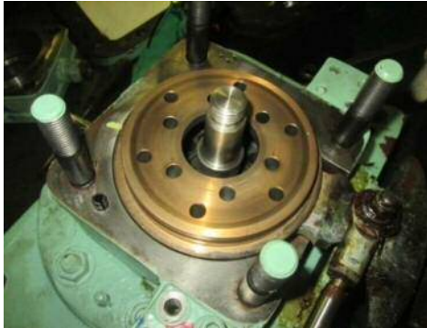
Overlap cylinder အတွက်- အပေါ်ကို ၆၀ ဒီဂရီ အောက်ကို ၂၀ ဒီဂရီပေးထားတယ်။
